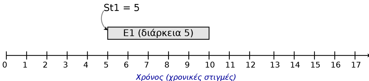
Σχήμα 12.3: Αναπαράσταση του χρόνου σε προβλήματα χρονοπρογραμματισμού. Στο σχήμα εμφανίζεται μια εργασία με διάρκεια 5 χρονικές στιγμές.
